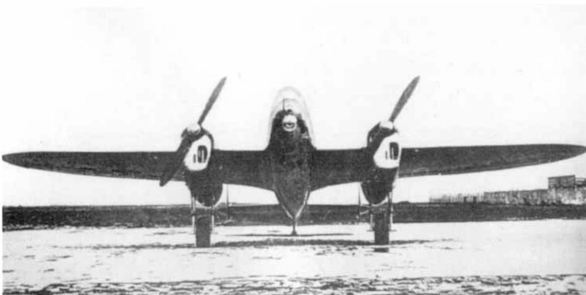
Widok z przodu PWS-33/I. Dysza prędkościomierza i celownik umieszczone niesymetrycznie.
