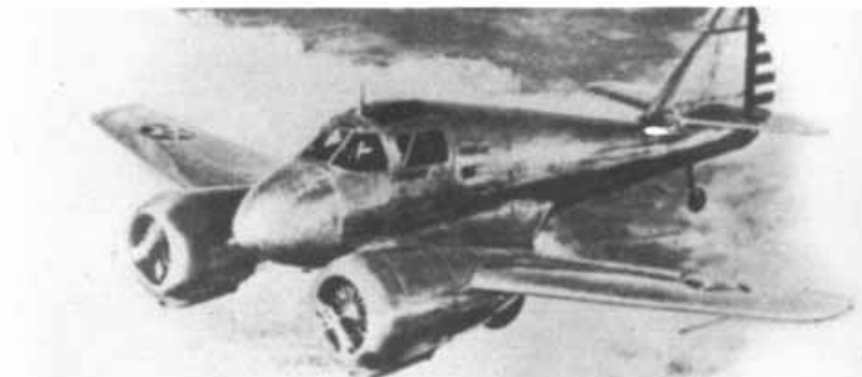
Curtiss (CW.25) AT-9 Fledgling. USA 1941, 791 szt, 2x295 KM, rozpiętość 12,2 m, Vmax=316 km/h
