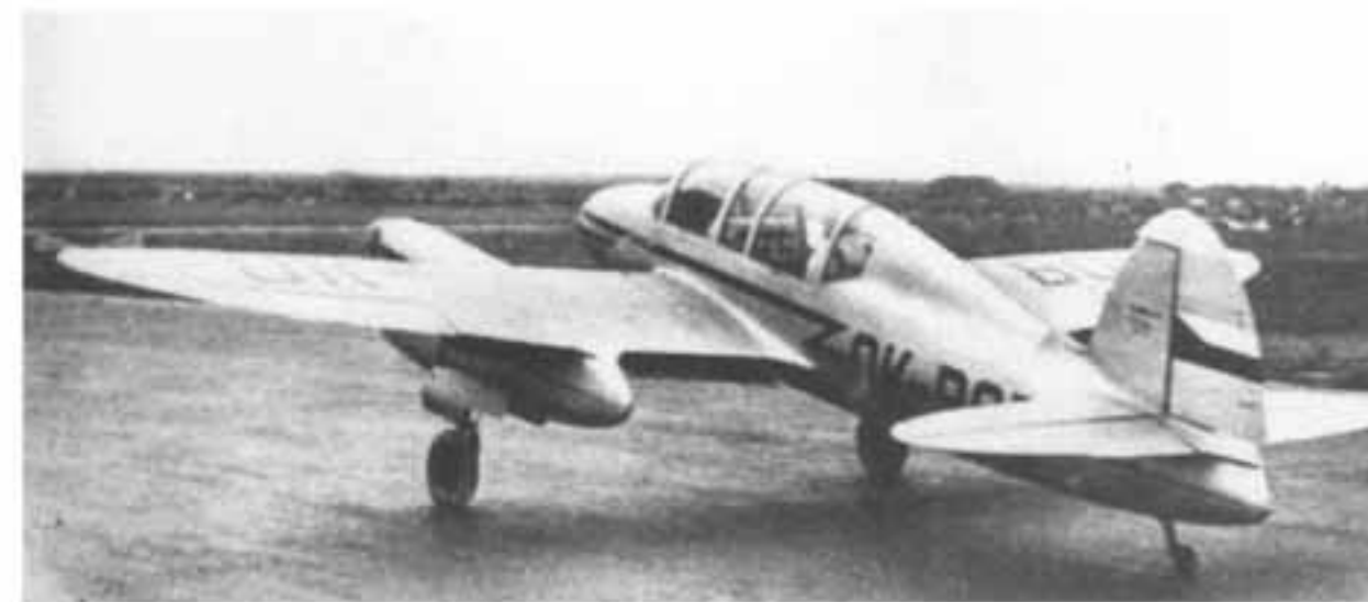
Sportowy Hodek HK-101. Czechosłowacja, 1947, 1 szt. 2x105 KM, rozpiętość 7,7 m, V max=350 km/h
